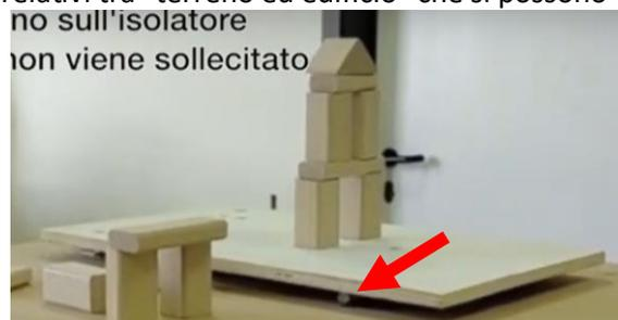
Il meccanismo di crisi per attrito visto qui sopra, viceversa, penso possa essere utile per fissare l’attenzione sul comportamento degli arredi durante le oscillazioni sismiche e sui pericoli di ribaltamento di armadi e, in genere, dispositivi con dimensioni ridotte della base. In questo caso mi riferisco, a titolo puramente indicativo, al **video C1**.
